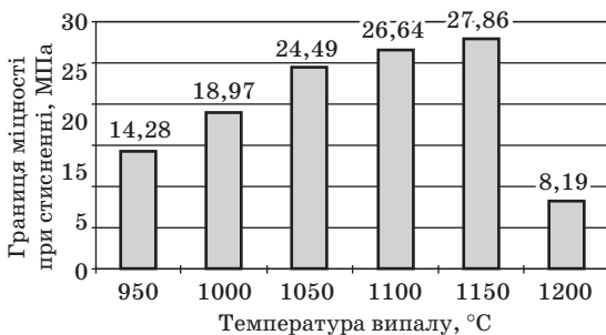
Рис. 4. Границя міцності при стисненні продуктів випалу глини
