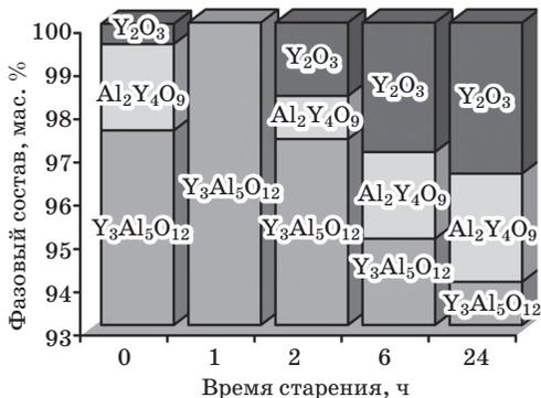
Рис. 3. Фазовый состав нанопорошков YAG:Nd, полученных прокалкой фазы-предшественника при  $T = 1000$  °С в течение 2 ч, в зависимости от времени старения осадка прекурсора
